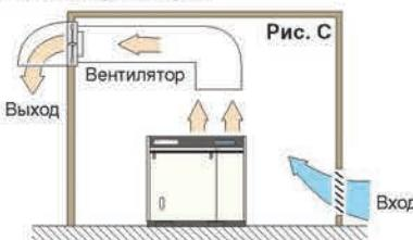
Крепление воздуховода заклепками к корпусу компрессора помешает его проверке. Лучше использовать гибкие воздуховоды из брезента.
